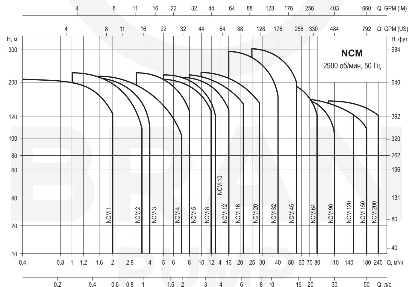
Графические характеристики оформлены в соответствии с ГОСТ ISO 9906-2015 (БЫ). Графики приведены для постоянной частоты вращения двигателя 2900 об/мин при испытаниях на воде с температурой 20 °C, с кинематической вязкостью 1 мм²/с (1 сСт), при отсутствии в воде пузырьков воздуха.
