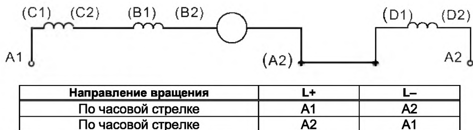
Рисунок А.24 – Двигатель с последовательным возбуждением, два вывода
