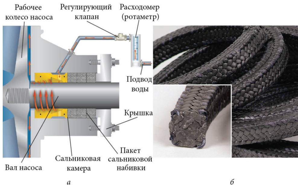
Рис. 30. Сальниковое уплотнение центробежного насоса для подачи осадков: а — устройство сальникового уплотнения; б — общий вид сальниковой набивки
