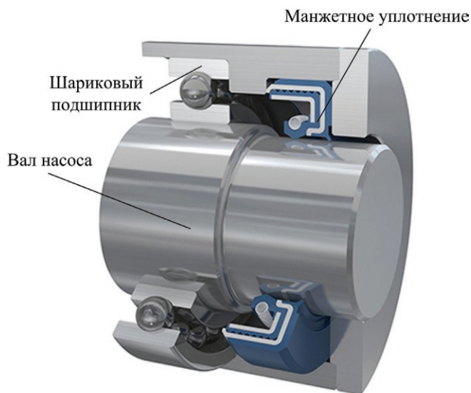
Рис. 31. Устройство манжетного уплотнения центробежного насоса
